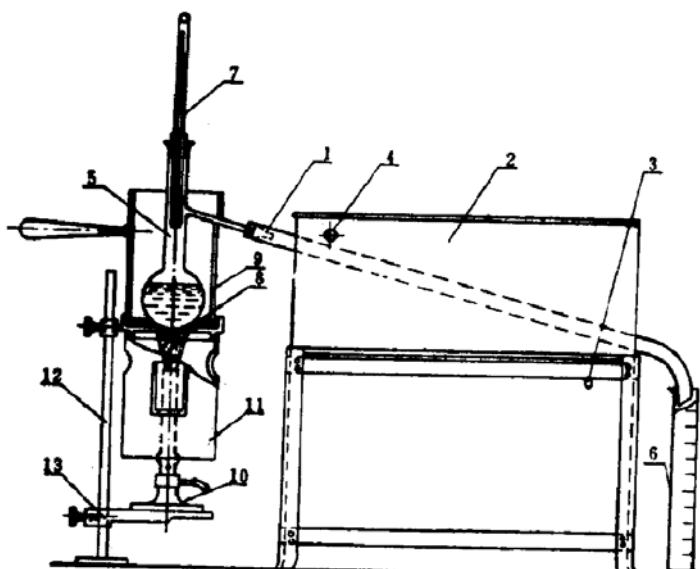
1—冷凝管；2—冷凝器；3—进水支管；4—排水支管；5—蒸馏烧瓶；
